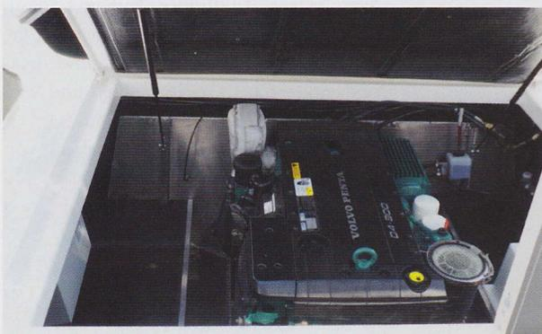
Aufgeräumt und sauber installiert: Der Volvo Penta D4-300 in seiner „Behausung“ im Achterschiff.
