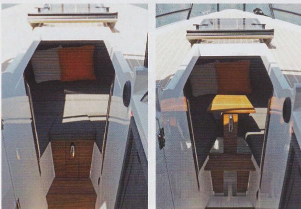
Pfiffig gelöst: Die ausziehbare Treppe für den Zugang zum Vordeck.
